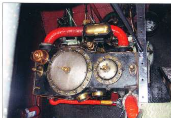
Maskinstoppen på den tvåcylindriga compoundmaskinen visar tydligt skillnaden mellan den lilla högtrycks- och den stora lågtrycks-cylindern. Foto Gunnar Söderberg 1 maj 2010
