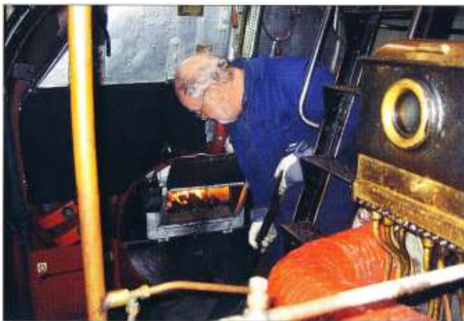
Bert Johansson är en av maskinisterna i färjan. Kolledningen är en konst som måste beprövas för att kunna producera ånga till maskinen. Foto Gunnar Söderberg 1 maj 2010.
